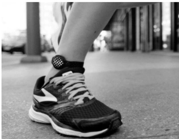
Рис. 5. Устройство Moov Now, содержащее девятиосевой датчик движения
