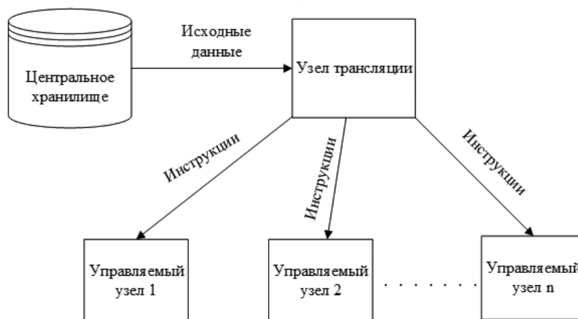
Рис. 1. Схема работы системы управления конфигурациями
