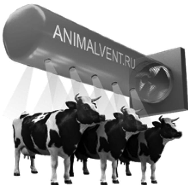
Рис. 5. Распределение воздушного потока между животными [5]
