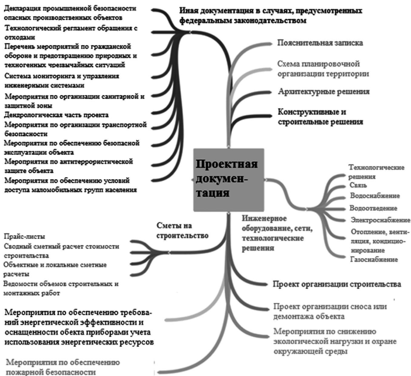
Рис. 1. Схема (структура) проектной документации
