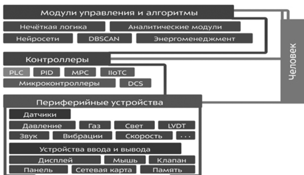
Рис. 1. Иерархическая структура ИКУ
