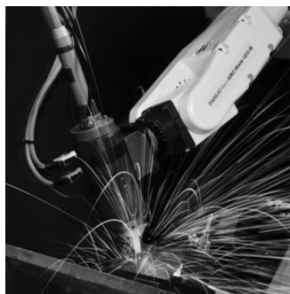
Рис. 1. Плазменная резка с использованием робота Fanuc
