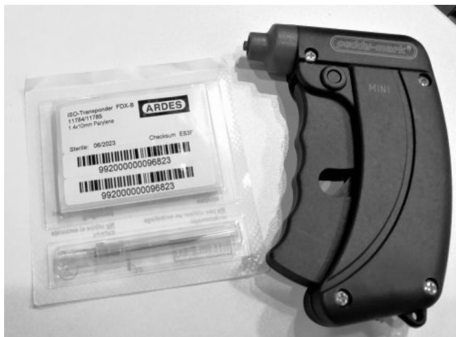
Рис. 1. Пример импланта RFID для животных Destron Fearing TX1400L; транспондеры FDX-B для имплантации под кожу домашних животных (1.4 x 10 мм)
