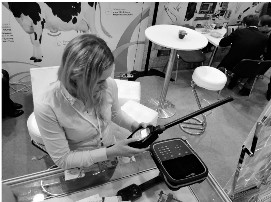
Рис. 4. Ручные считыватели меток на стенде ISBC представлены моделями Biocontrol HHR3000Pro (на фото) и Agrident AWR300. Оба считывателя совместимы с программным комплексом Селэкс, разработки РЦ «Плинор». | MForum.ru Все иллюстративные материалы взяты и переработаны из статьи «RFID в животноводстве. Ветеринария и RFID — Применение RFID»
