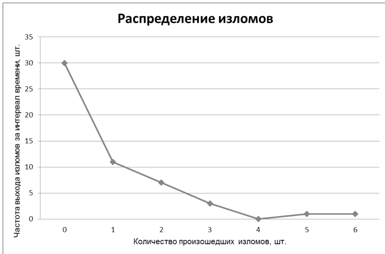
Рис. 3. Эмпирическое распределение изломов рельсов
