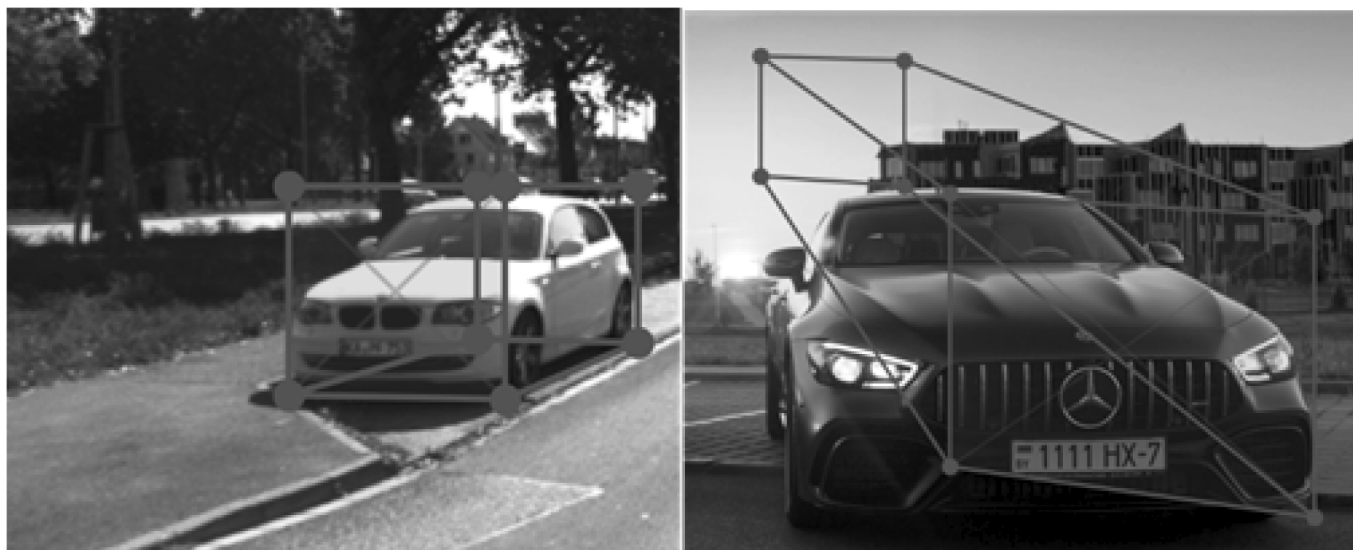
Рис. 3. Пример распознавания YOLO3D ограничивающей рамки на изображении. Слева представлен результат с известной геометрией исходного обучающего множества. Справа неточное распознавание по тестовому изображению из целевого датасета
