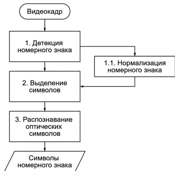
Рис. 1. Классическая схема распознавания номерных знаков с возможным дополнительным (1.1) шагом нормализации
