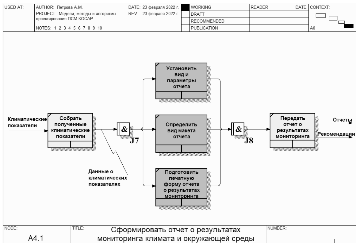
Рис. 7. Схема ОПЭРП «Сформировать отчет о результатах мониторинга климата и окружающей среды»
