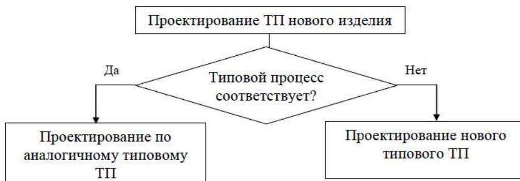
Рис. 2. Схема проектирования типового технологического процесса
