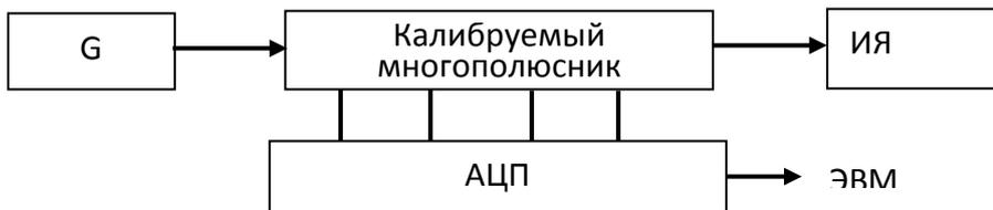
Рис. 1. Схема установки для измерения параметров диэлектриков
