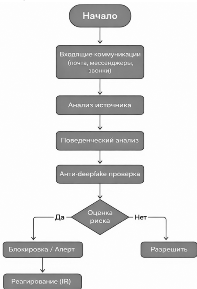
Рис. 2. Блок-схема алгоритма применения искусственного интеллекта в средствах защиты информации
