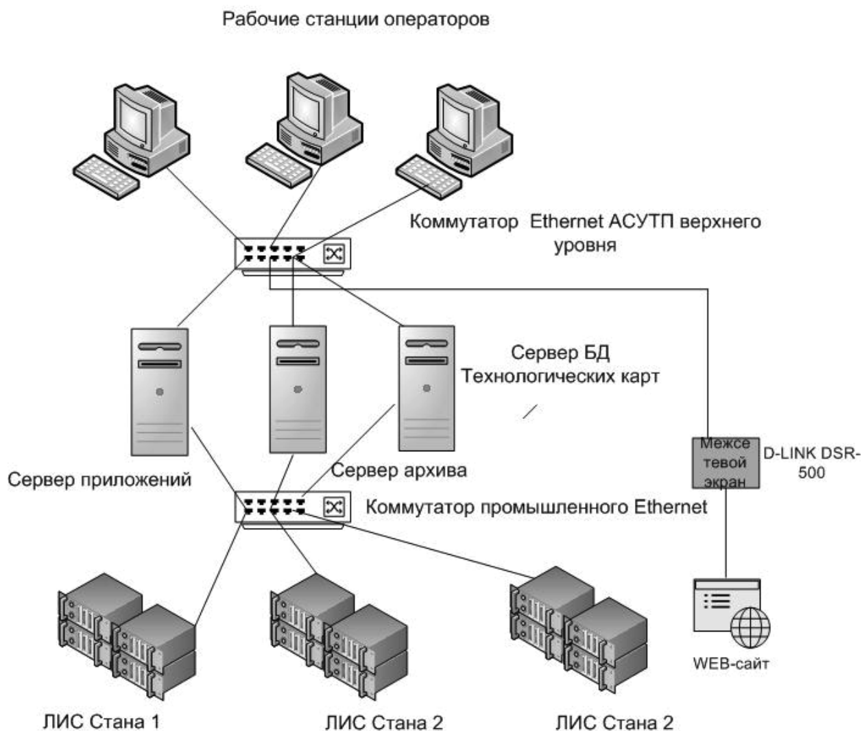
Рис. 1. Структурная схема АСУТП
