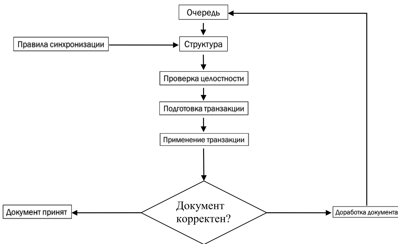
Рис. 2. Схема процесса синхронизации документа
