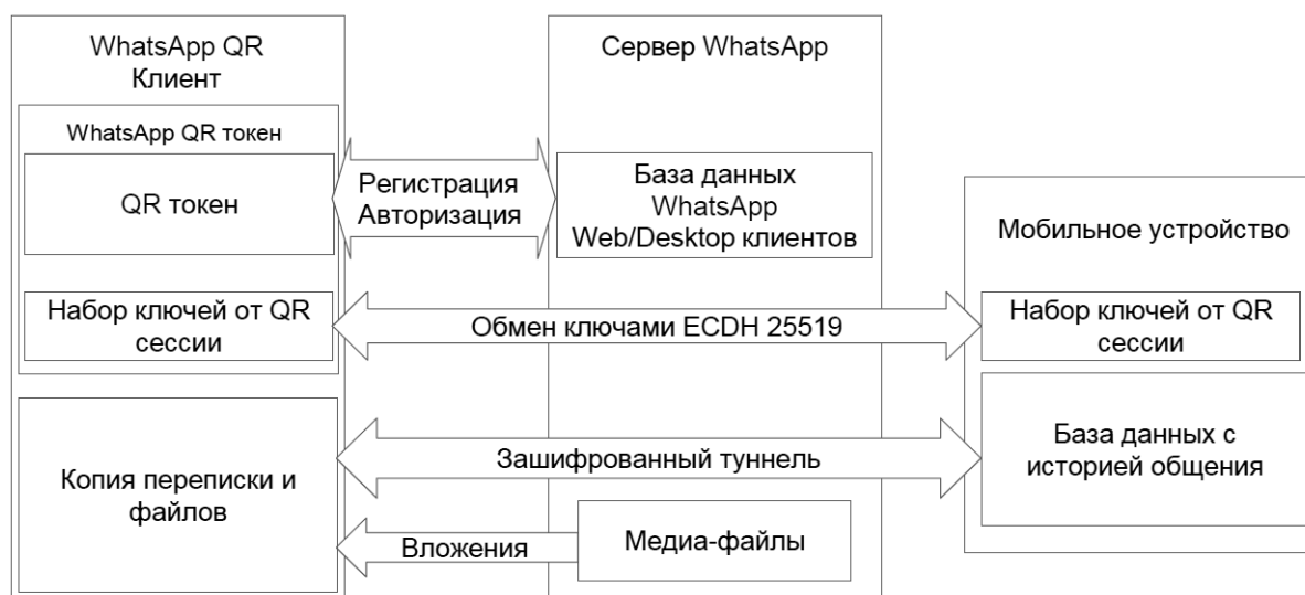
Рис. 2. Схема работы механизма WhatsApp QR
