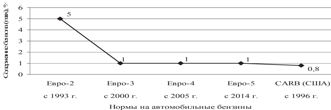
Рис. 1. Максимально допустимое содержание бензола в товарных автомобильных бензинах
