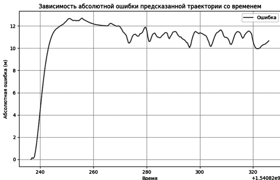
Рис. 5. Абсолютная ошибка отклонения предсказанной (инерциальный блок и нейросетевая навигация) от истинной траектории БПЛА
