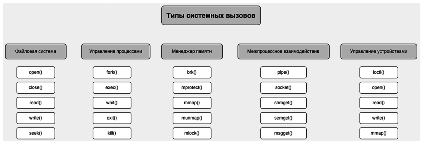
Рис. 1. Классификация системных вызовов в Linux (составлено автором на основе [1])
