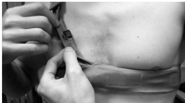
Рисунок 3. Фотография кардиологического пояса с установленными датчиками EPIC на пациенте (вид спереди).
