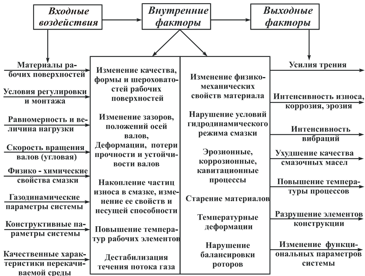
Рис. 2. Структура представления взаимодействия элементов системы и связи входных событий с выходными признаками
