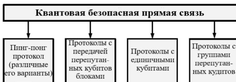
Рис. 3. Протоколы квантовой прямой безопасной связи
