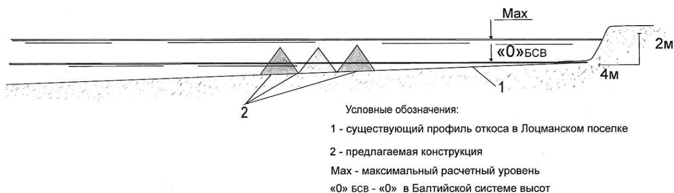
Рис. 2. Устройство берегозащитной конструкции для района Лоцманского поселка.
