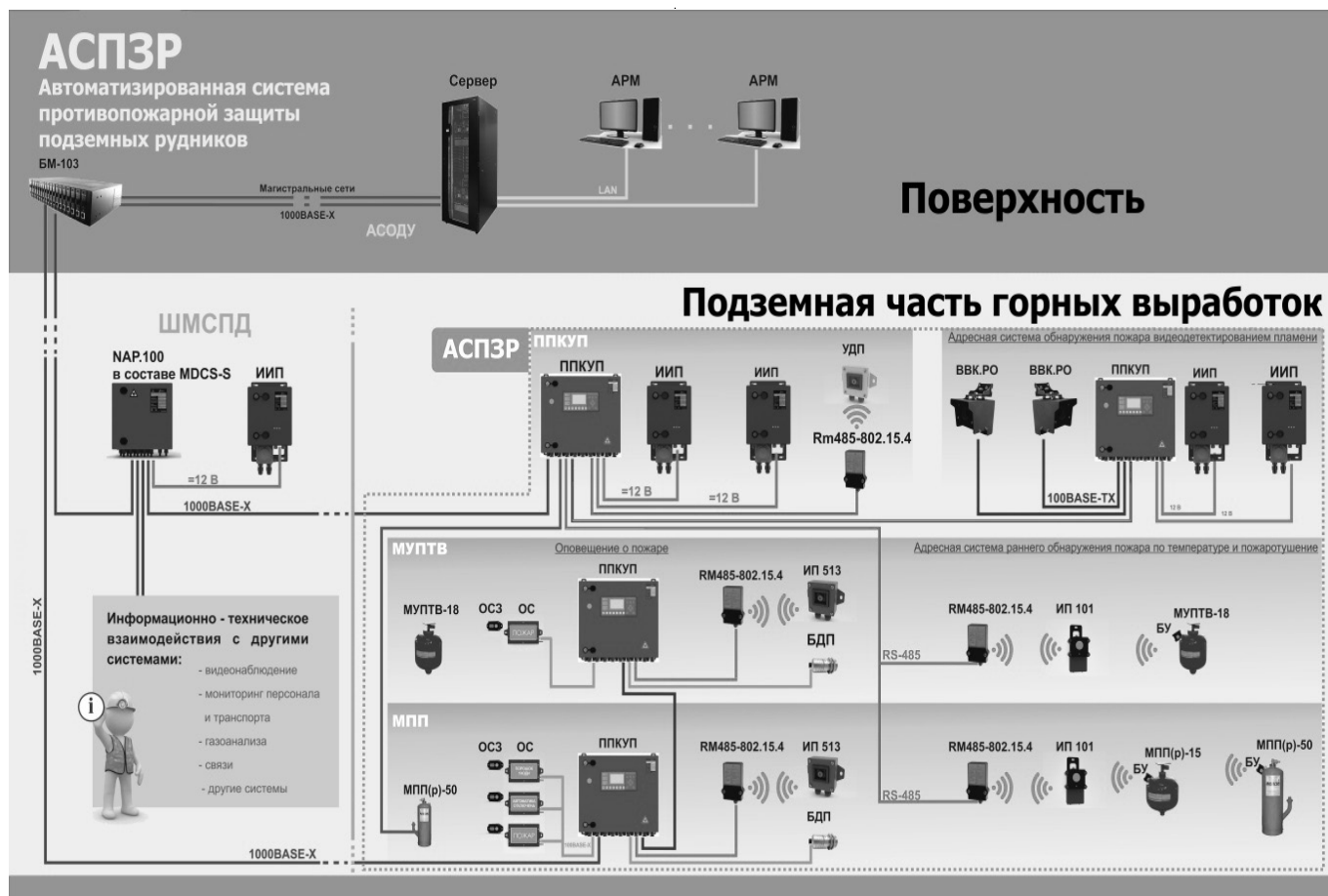
Рис. 1. Структурная схема комплекса технических средств автоматизированной системы противопожарной защиты подземных рудников (АСПЗР) с беспроводным интерфейсом:
