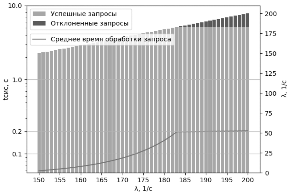
Рис. 5. Зависимость времени ответа системы от входящей нагрузки с ограничением частоты запросов
