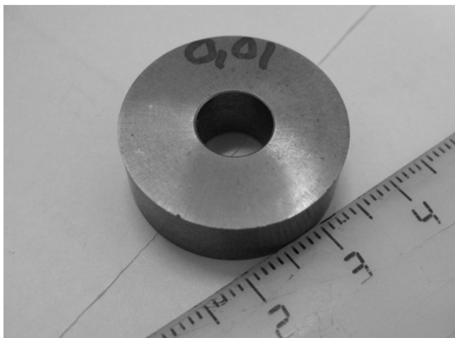
Рис. 2. Вырезанная заготовка из спеченного твердого сплава под мелко модульную червячную фрезу на электроэрозионном станке.
