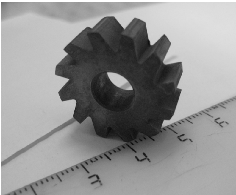
Рис. 3. Заготовка мелко модульной твердосплавной червячной фрезы с вырезанными стружечными канавками на электроэрозионном станке.
