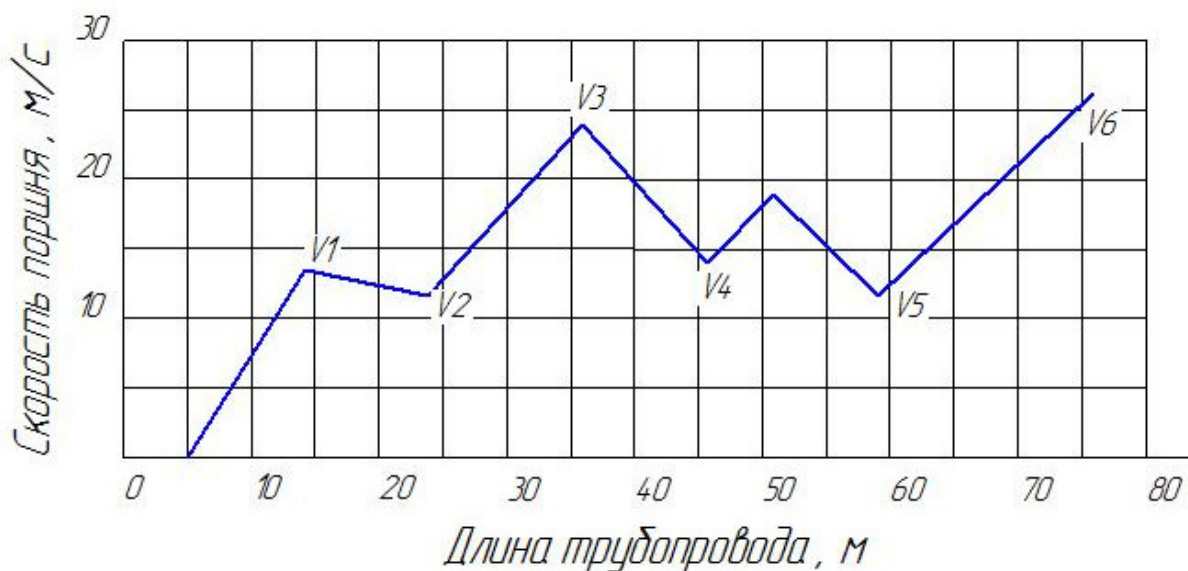
Рис. 7. Скорость поршня по длине трубопровода.
