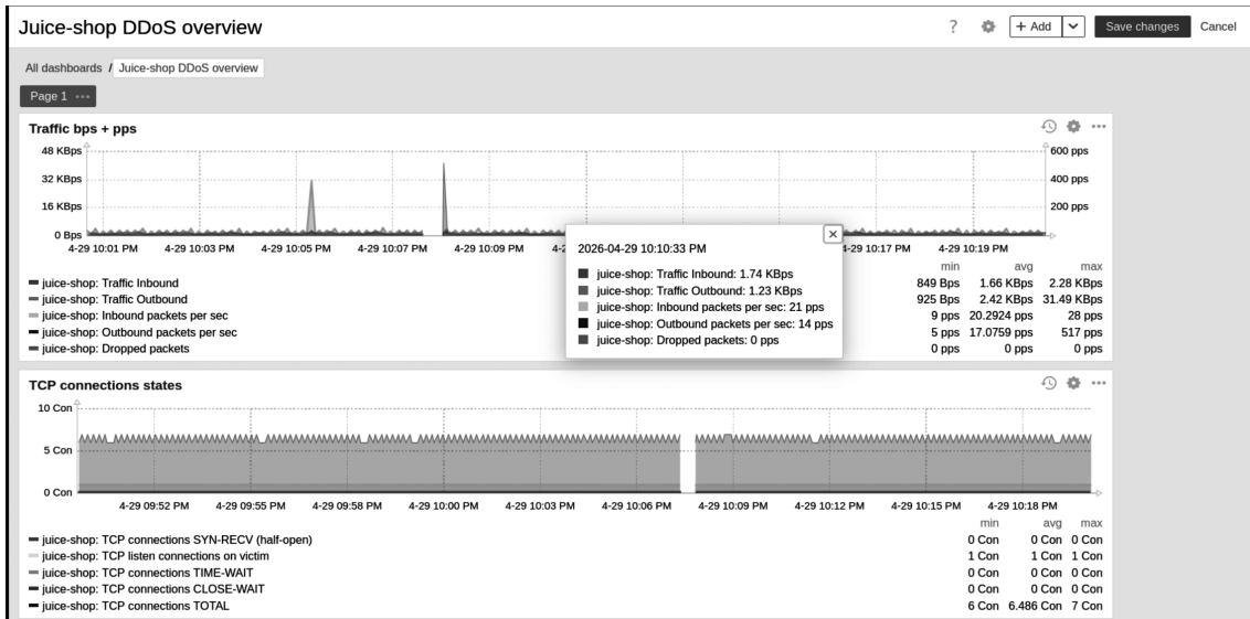
Рис. 2. Состояние хоста до атаки: трафик и TCP-соединения
