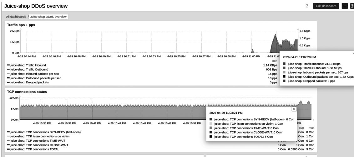
Рис. 3. Начало DDoS-атаки: рост трафика и TCP TOTAL, выход CPU на 100 % и рост времени отклика
