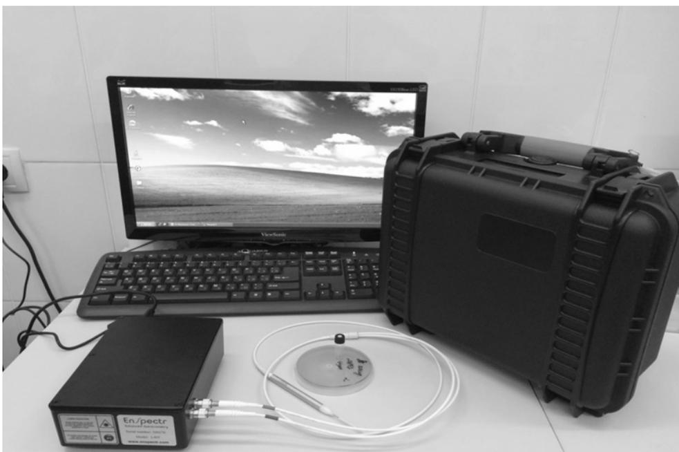
Рис. 1. АПК «ИнСпектрМ» со световодной насадкой
