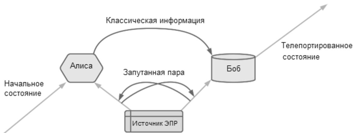
Рис. 3. Результаты работы протокола CSLOE-2022, где источник ЭПР представляет собой источник фотонов, предложенный Эйнштейном–Подольским–Розеном
