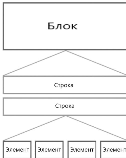
Рис. 1. Сегментация текста на блоки, строки, элементы и символы
