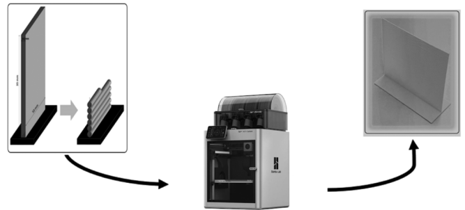
Рис. 1. Представление вертикальной стенки, примененной машины FDM и печатного твердого тела
