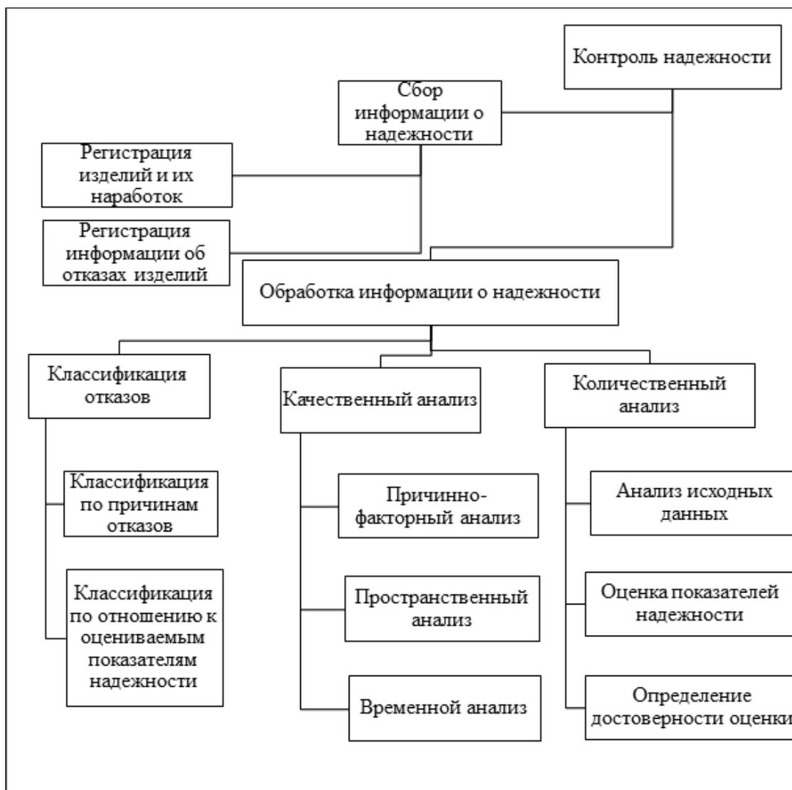
Рис. 1. Иерархическая модель работ по контролю надежности для изделий сложной технической аппаратуры.
