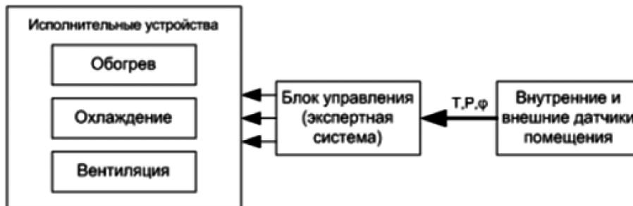
Рис. 1. Схема работы традиционной системы интеллектуального управления микроклиматом (источник: составлено автором на основе [1–9])
