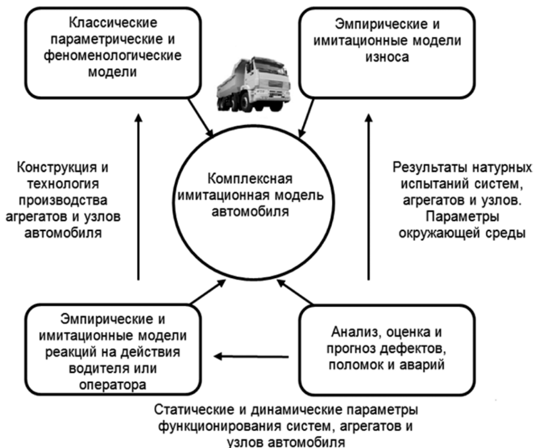
Рис. 1. Компоненты комплексной модели роботизированного автомобиля
