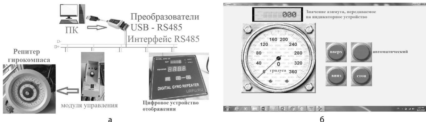
Рис. 22. Схема подключения компьютера и тестовых устройств (а), Интерфейс ПО для тестирования индикаторных устройств (б)
