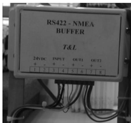
Рис. 8. Результат разработки буфера RS485-NMEA0183
