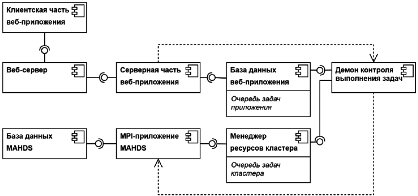
Рис. 2. UML диаграмма компонентов системы для построения множественных выравниваний методом MAHDS
