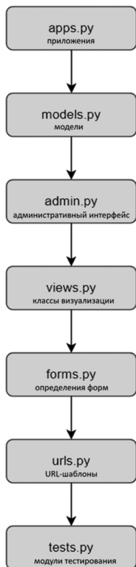
Рис. 1. Последовательность блоков кода Django-приложения
