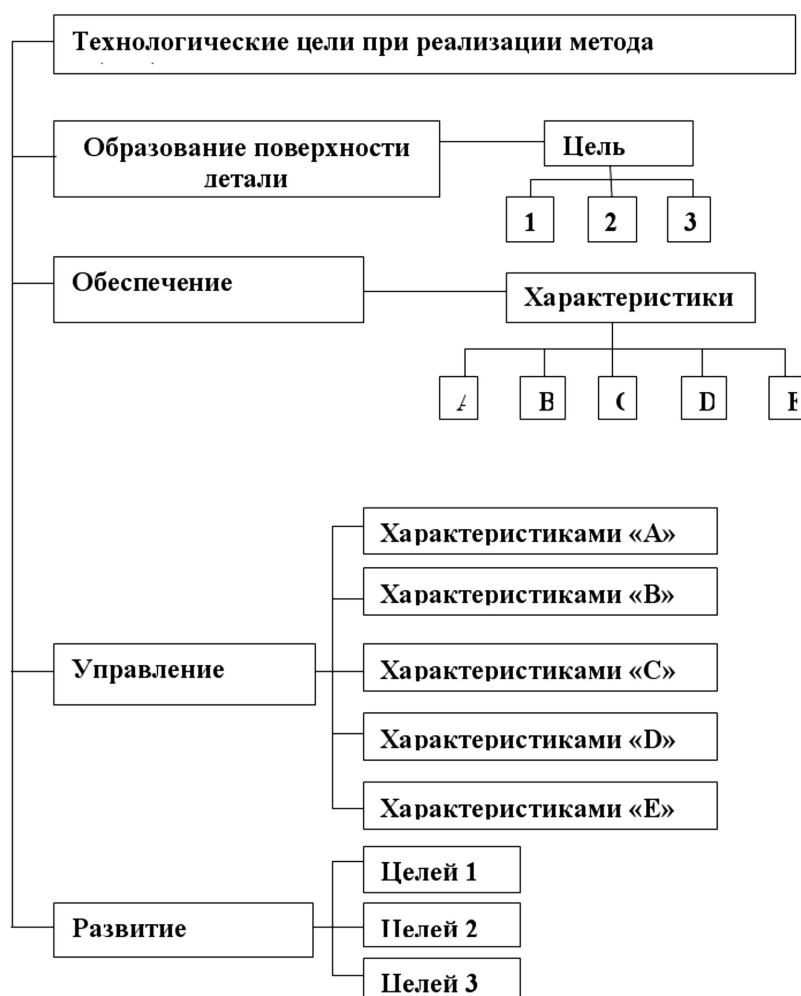
Рисунок 1. Структура технологических целей: 1 - min затрат; 2 - max производительности; 3 - заданного качества детали; А - статистические; В - динамические; С - инструмента; D - кинематические; E - способа воздействия.
