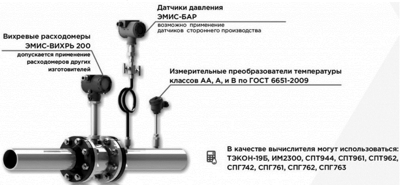
Рис. 3. Состав автоматической системы контроля газовых котельных
