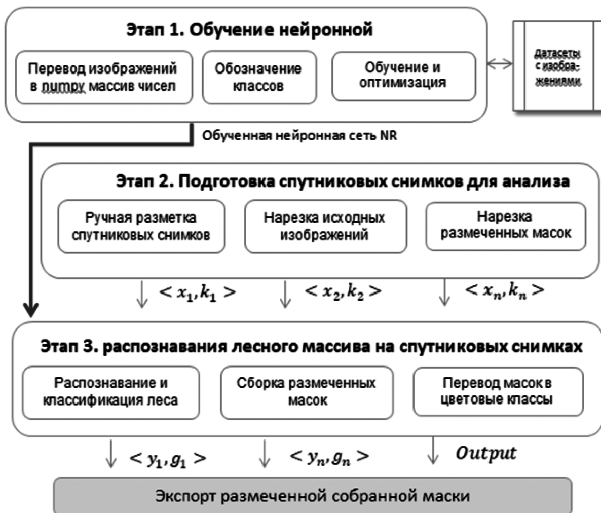
Рис. 3. Алгоритм модели классификации лесного массива по спутниковым снимкам
