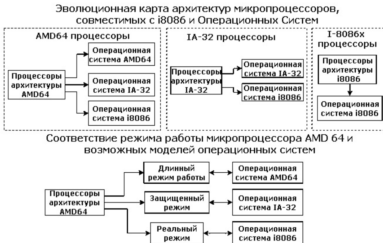
Рис. 3. Структурная схема взаимосвязи режимов микропроцессора и доступной операционной системы.
