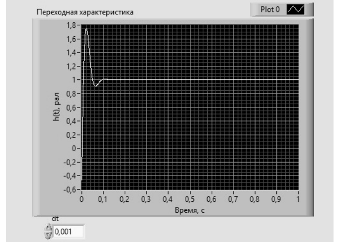
Рис. 5. График переходной характеристики системы
