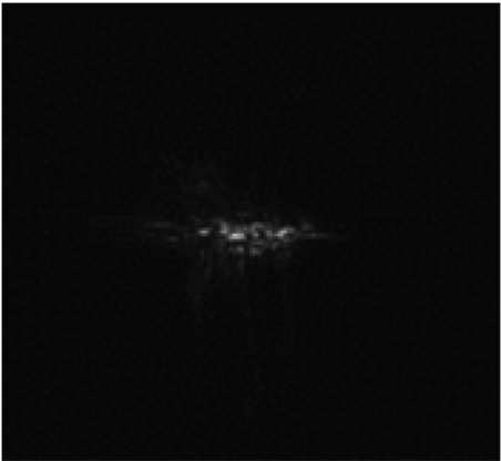
Рис. 5. Изображение светящегося пятна в фокусе асферического зеркала
