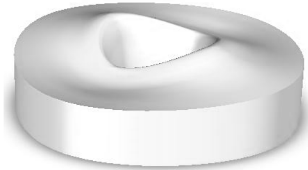
Рис. 6 – Образование «седла» в наплыве отпечатка при действии сжимающих или растягивающих остаточных напряжений
