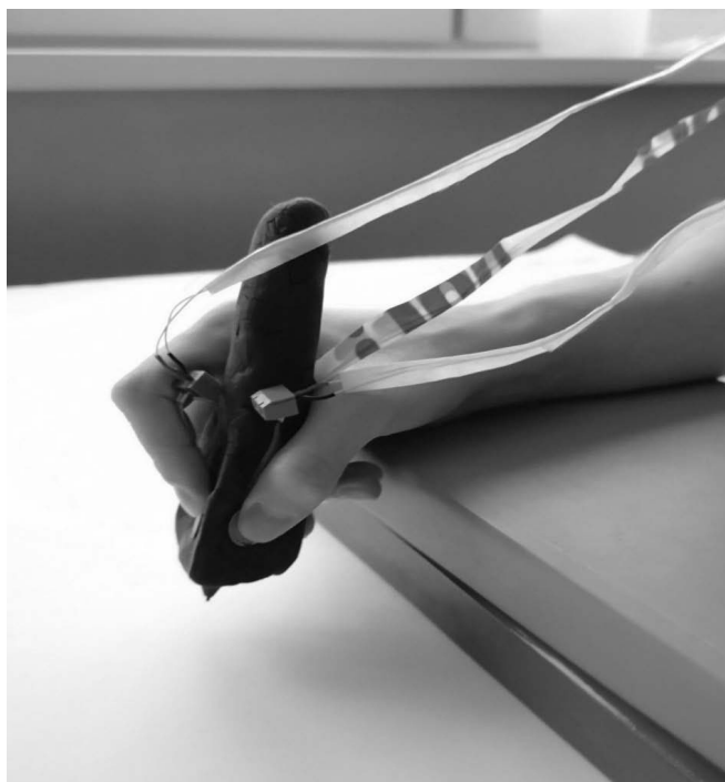
Рис. 1. Удержание заданного усилия с помощью тензодатчика встроенного в ручку штативным захватом
