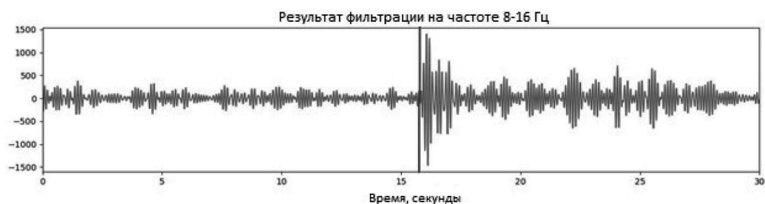
Рис. 3. Отфильтрованные данные тензотремометрии испытуемого в условии «штативного захвата ручки» [по вертикальной оси % МПС/Гц, по горизонтальной оси – время], вертикальной линией – время подачи стимула «Звук».
