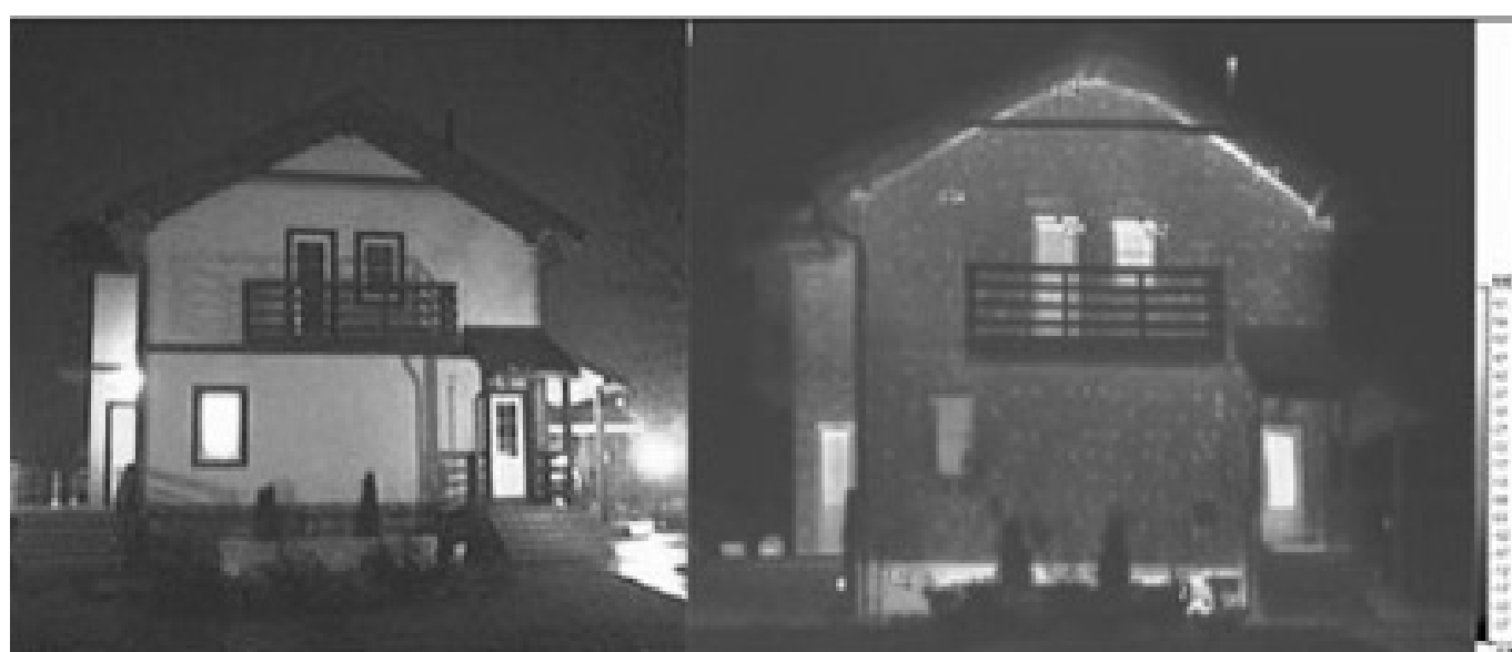
Рис. 3. Определение точек утечки тепла из жилого дома [6]
