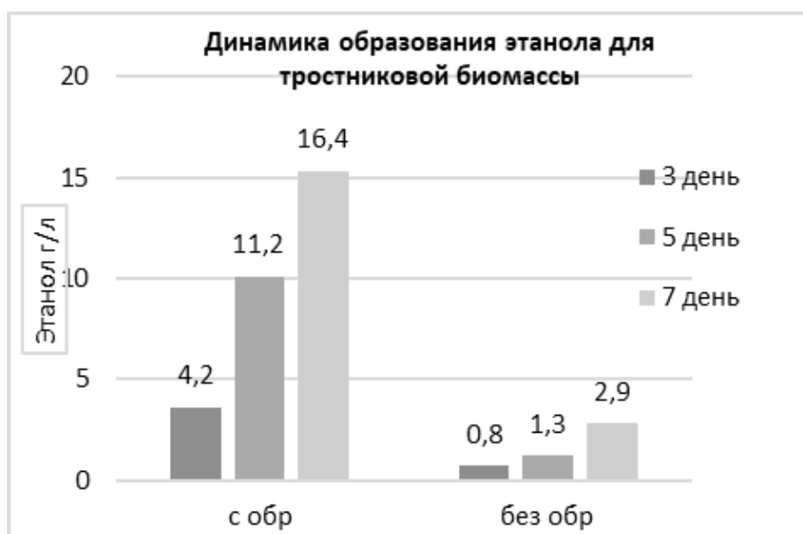
Рис. 1. Динамика образования этанола для тростниковой биомассы с применением предварительной обработки (а) и без предварительной обработки (б) на 3,5 и 7 сутки
