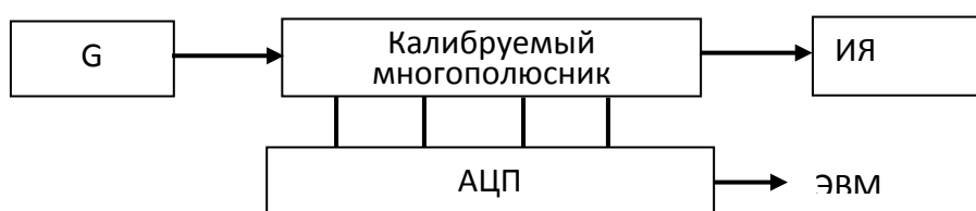
Рис. 1. Схема установки для измерения параметров диэлектриков
