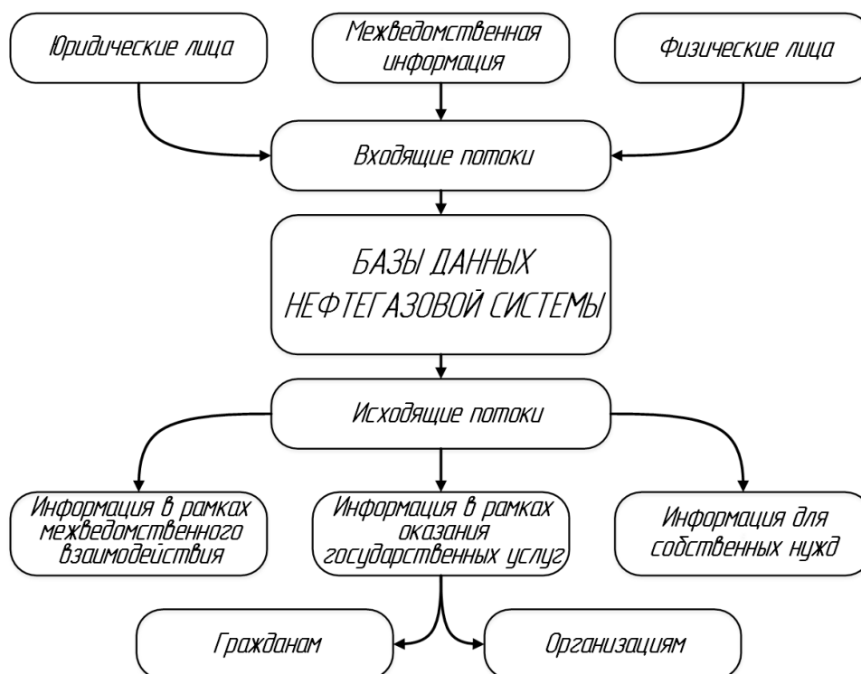
Рис. 1. Потоки информационных баз данных нефтегазовой системы
