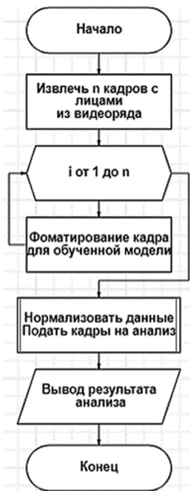
Рис. 6. Блок-схема алгоритма получения результата предугадывания
