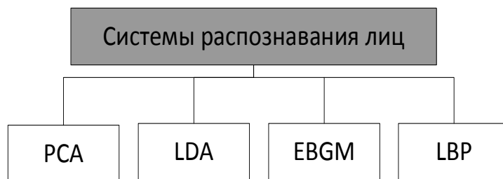
Рис. 1. Основные методы системы распознавания лиц [6]: PCA — метод главных компонент; LDA — дискриминантный анализ; EBGM — эластичные графовые модели; LBP — локальные бинарные шаблоны
