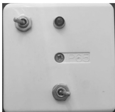
Рис. 3. Рабочая панель физической модели блока для автоматического отключения двигателя автомобиля
