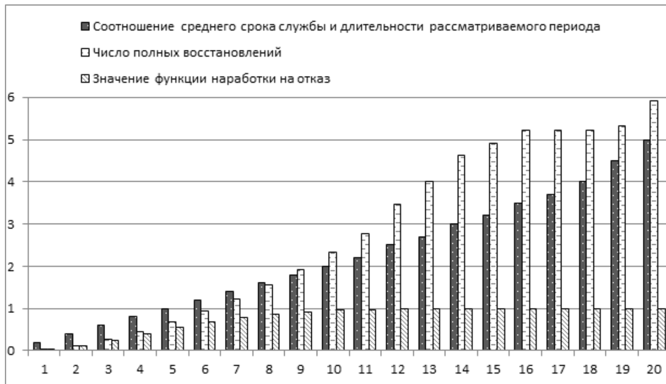
Рис. 3. Зависимость ожидаемого числа полных восстановлений от соотношения среднего срока службы и длительности рассматриваемого периода.
