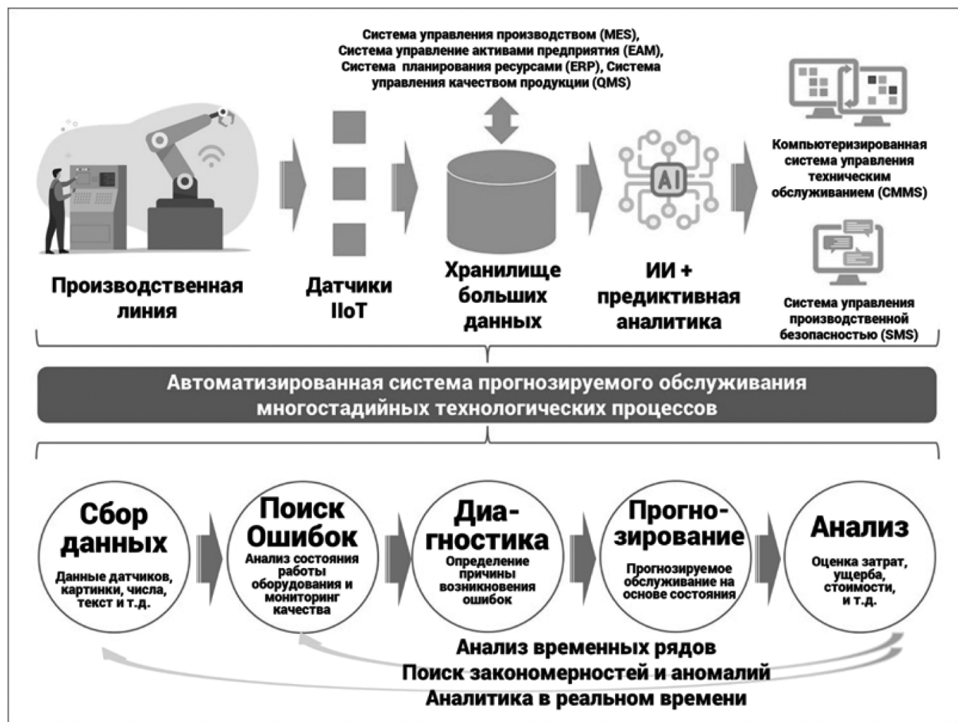
Рис. 6. Пример автоматизации процесса прогнозируемого обслуживания
