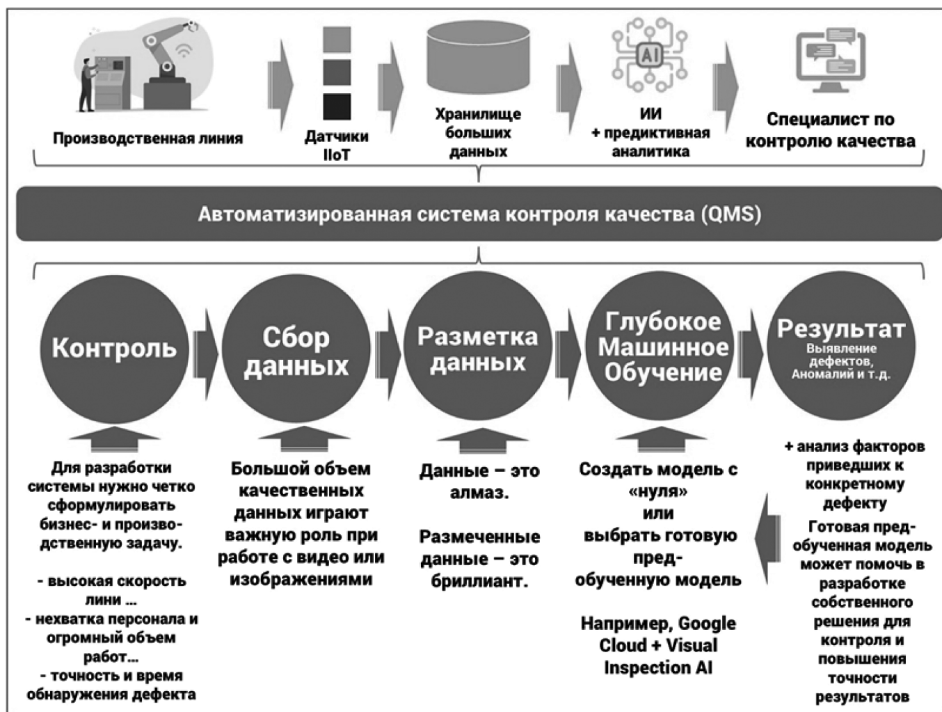
Рис. 4. Пример автоматизации процесса контроля качества продукции
