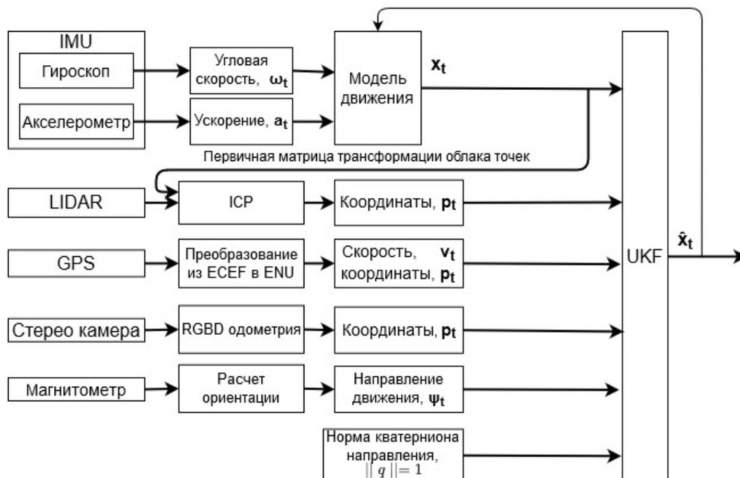
Рис. 1. схема объединения измерений с GPS, IMU и лидаров
