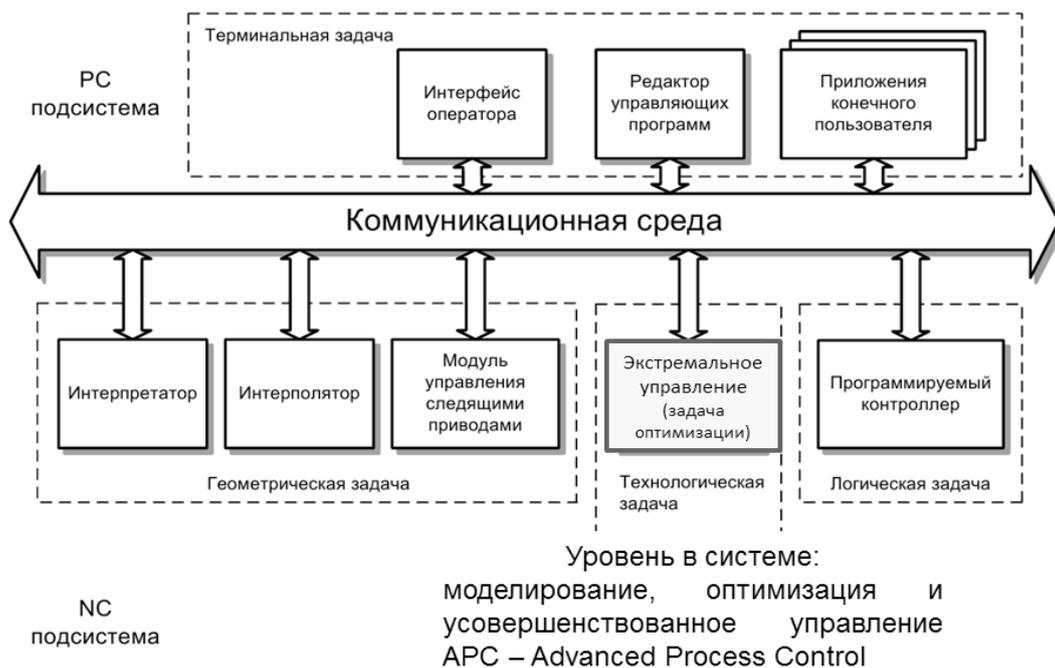
Рис. 2. Место оптимального управления в системе ЧПУ
