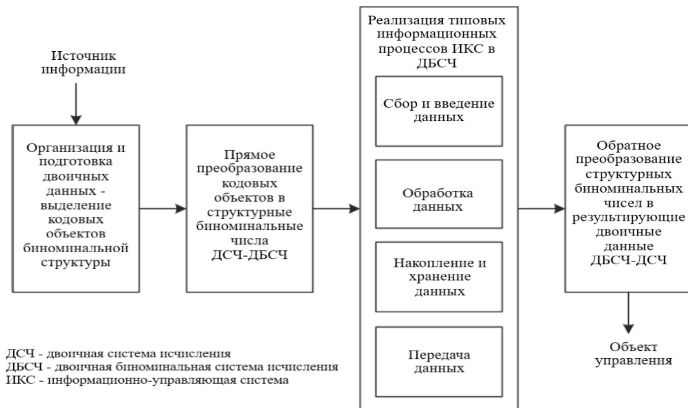
Рис. 1. Концепция разработки информационно-управляющей системы, использующая биномиальную двоичную систему чисел
