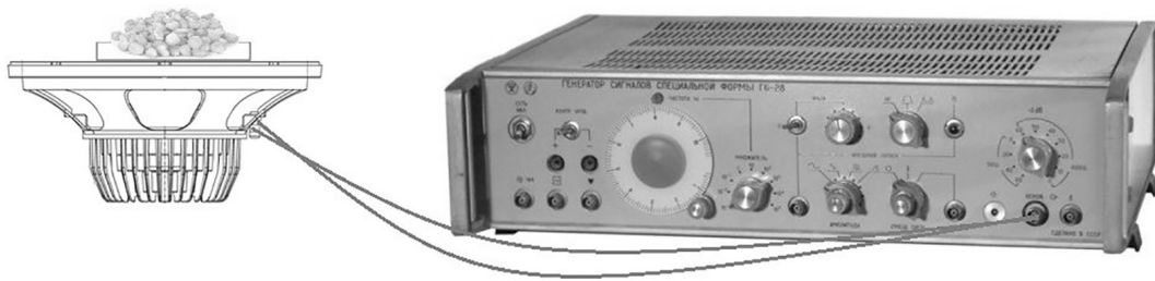
Рис. 2. Экспериментальная вибрационная установка для обработки семян низкочастотной вибрацией
